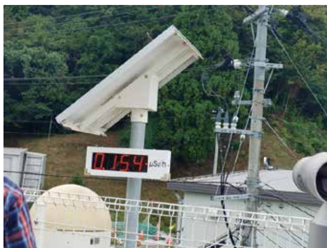
図13 埋立処分施設近傍で確認した空間線量率
