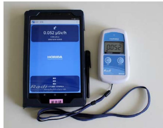
図1. 環境放射線モニタ（堀場製作所 Radi PA-1100）と Android™ タブレット端末（HUAWEI d-02H）
