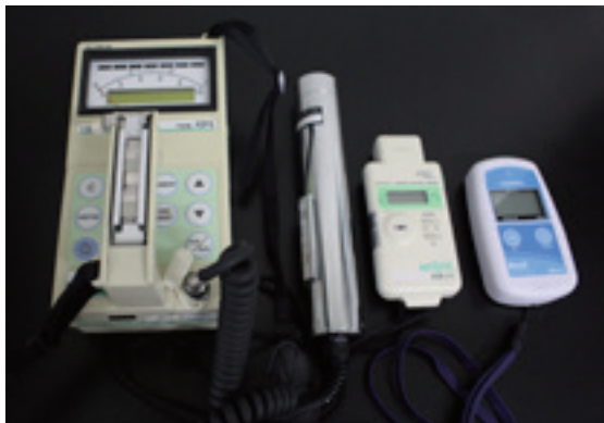
図4 使用した測定機器（左より NaI シンチレーション式サーベイメータ、ポケットサーベイメータ MYRATE、ポケットサーベイメータ Radi）
