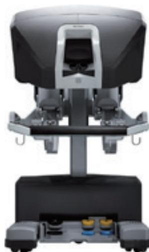
図16 サージョンコンソール（操作部） [20]
